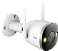
Bullet IP/Wi-Fi da interno/esterno IP67, sensore CMOS progressivo 1/3", risoluzione 4 MP a 25/30fps, H.265, visione notturna con portata 30 m, ottica fissa 2.8 mm, zoom digitale 16x, 1 porta LAN 100 Mbps, Wi-Fi IEEE802.11 b/g/n doppia antenna, app Imou per iOS e Android, microfono, speaker, riflettore e sirena 110 dB integrati, tasto reset, motion detection, human detection, slot micro SD card (fino a 256 GB), alimentazione 12 Vdc <7 W, alimentatore incluso
