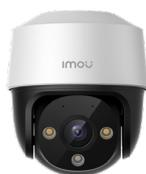
PTZ IP da interno/esterno IP66 sensore CMOS progressivo 1/3", risoluzione 4 MP a 25fps, H.265, visione notturna con portata 30 m, ottica fissa 3.6 mm, zoom digitale 16x, 1 porta LAN 100 Mbps, app Imou per iOS e Android, microfono, tasto reset, motion/human detection, zone configurabili, slot micro SD card (fino a 256 GB), alimentazione PoE <6.2W
